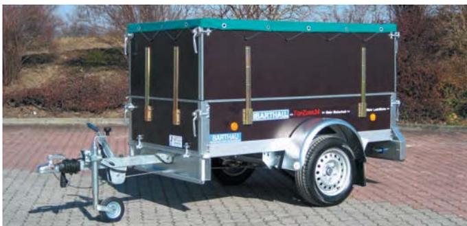
**GL 1001 mit serienmäßigem leichtem Stützrad und Auflaufbremse.** Als **Zubehör** Aufsätze 600mm hoch und Flachplane in hollandgrün RAL6026 sowie Stoßdämpfer. Die Aufsätze sind bei Bedarf abnehmbar.
