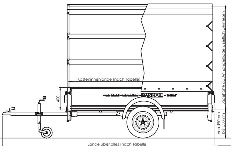
Dachgestell mit Giebel, in der Mitte mit 100mm Steigung. PVC-Plane mit Perlonseil unten, an den Ecken hinten mit Zick-Zack Verschluss leicht zu verschließen.
