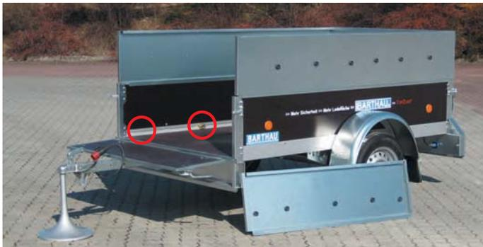
**Optimale Raumausnutzung + Verzurrmöglichkeiten. Es geht kein Laderaum verloren** wie bei versenkten Anbindungen.
