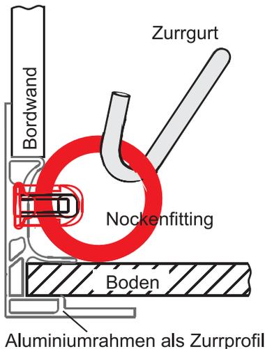
Bei Anhängern vom Typ GL und GS sind immer beide Längsseiten mit einem Aluminiumrahmen speziell als Zurrprofil ausgebildet. Die Nockenfittings für die Zurrgurtaufbefestigung werden im Aluminiumprofil versenkt befestigt.
