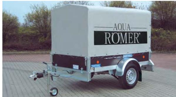
**GL 1351 mit Zubehör Dachgestell und Plane** 1000mm hoch sowie Stoßdämpfer für Zulassung 100km/h und Werbebeschriftung dreiseitig.
