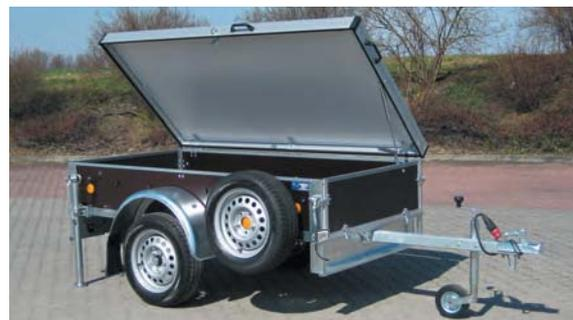
**GL 751 mit Zubehör Thermodeckel, Rohrstützen** mit einfacher Klemmhalterung, Ersatzrad mit Halterung und Stützrad leicht.
