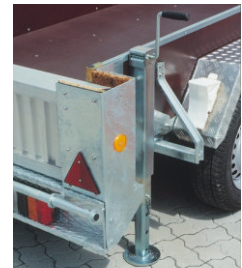
Geräuschdämmung an der Rampenhalterung durch serienmäßig montierte Kokosmatte (nur bei GTA). Teleskopstütze, mit Steckbolzen absenkbar, dann Feineinstellung über Handkurbel.
