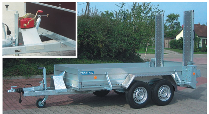
GTB 3502 mit Aluminium-Bordwänden 400 mm hoch. Serienmäßig Einsteckteil aus Stahlblech zwischen den Rampen und Zwangsabstützung der Aluminium-Auffahrampen. Zubehör: Windenbock mit Umlenkung für Seilwinde , zentral auf den V-Zugholmen montiert, Zugseil wird durch die Stirnwand geführt.
