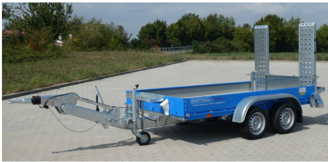
BS 3502 serienmäßig mit blau farbeschichtetem Rahmen und Aufbau. Zubehör: Höhenverstellbare Auflaufbremse mit LKW-DIN-Zugöse, verstellbar von 400 bis 1100 mm Anhängöhe (auf Wunsch mit Kugelkupplung wechselbar.) Einsteckbrett hinten zwischen den Rampen und Baggerlöffelablage vorne am Aufbau montiert.
