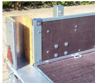
Geräuschdämmung an der Rampenhalterung durch serienmäßig montierte Kokosmatte (nur bei GTA). Teleskopstütze, mit Steckbolzen absenkbar, dann Feineinstellung über Handkurbel.
