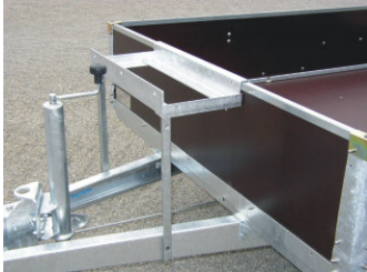
Baggerlöffelablage , an der Bordwand montiert, mit Abstützung auf die Zugdeichsel. Verwendung bei V-Deichsel und bei höhenverstellbarer Auflaufbremse (GTA / GTB / BS) möglich.
