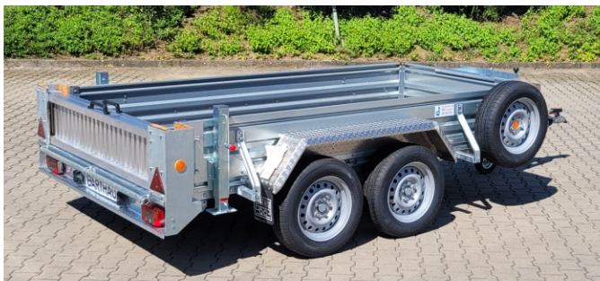
GTA 2702 mit Stahlblech-Bordwänden 400 mm hoch. Serienmäßig Aluminium - Auffahrampen hinten zum Transport quer eingesteckt. Zwei stabile Vierkantstützen mit Fallhub und Steckbolzen, Feineinstellung durch Kurbel, Tragkraft 1500kg/Stück. Zubehör: Ersatzrad mit Halterung , seitlich an der Bordwand montiert.
