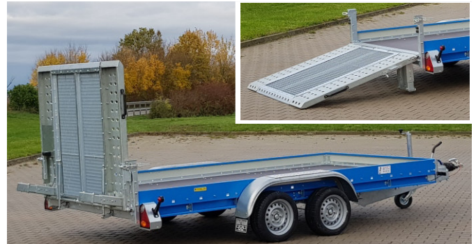
BS 3502 mit Gitterrostklappe 1500 mm hoch mit Zwangsabstützung zum Auffahren mit Maschinen und Geräten. Griffe Oberfläche, auch bei nassem Wetter kein Abrutschen möglich. Bedienerfreundlich, leichtes Anheben durch Gasfeder Unterstützung.
