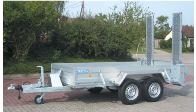
GTB 3502 mit Aluminium-Bordwänden 400 mm hoch. Serienmäßig Einsteckteil aus Stahlblech zwischen den Rampen und Zwangsabstützung der Aluminium-Auffahrampen.
