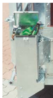
Geräuschdämmung an der Rampenhalterung durch serienmäßig montierte Kokosmatte (nur bei GTA). Teleskopstütze , mit Steckbolzen absenkbar, dann Feineinstellung über Handkurbel, Tragkraft 1500 kg/Stk.
