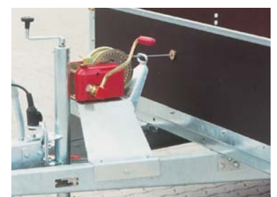
Seilwinde , 900 kg Zugkraft, mit Abrollautomatik, Windenbock mit Umlenkung, zentral auf den V-Zugholmen montiert, Zugseil durch die Stirnwand geführt.
