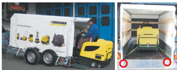
Flacher Auffahrwinkel durch Absenkung und lange Ladeklappe.
