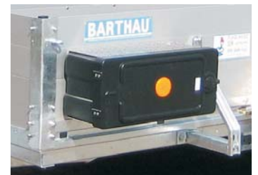
Staubbox PE Kunststoff an der Bordwand montiert.
