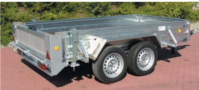
GTA 2702 mit Stahlblech-Bordwänden 400 mm hoch. Serienmäßig Aluminium - Auffahrampen hinten zum Transport quer eingesteckt. Zwei stabile Vierkantstützen mit Fallhub und Steckbolzen, Feineinstellung durch Kurbel, Tragkraft 1500kg/Stück.
