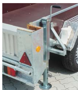
Geräuschdämmung an der Rampenhalterung durch serienmäßig montierte Kokosmatte (nur bei GTA). Teleskopstütze , mit Steckbolzen absenkbar, dann Feineinstellung über Handkurbel, Tragkraft 1500 kg/Stk.
