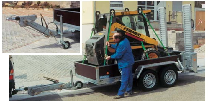
GTB 3502 mit Multiplex-Bordwänden 400 mm hoch, hinten Werkzeugbox serienmäßig (nur bei GTB). Zubehör: Höhenverstellbare Auflaufbremse mit LKW-DIN-Zugöse, verstellbar von 400 bis 1100 mm Anhänghöhe (auf Wunsch mit Kugelkupplung wechselbar).
