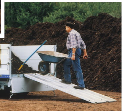
DK 2702 mit Zubehör : Alu-Auffahrampen mit Halterung unter der Ladefläche und 2 Klappstützen, Aluminium-Aufsätze 400 mm hoch, werkzeuglos steckbar, heckseitig Pendelbordwand.
