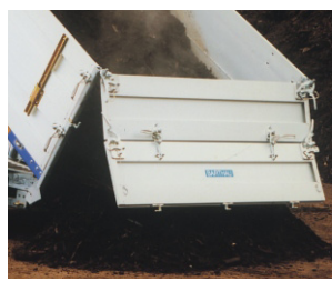
DK 2702 mit Zubehör : Laubgitter feuerverzinkt, 600 mm hoch, werkzeuglos steckbar, 3seitig zum Pendeln.
