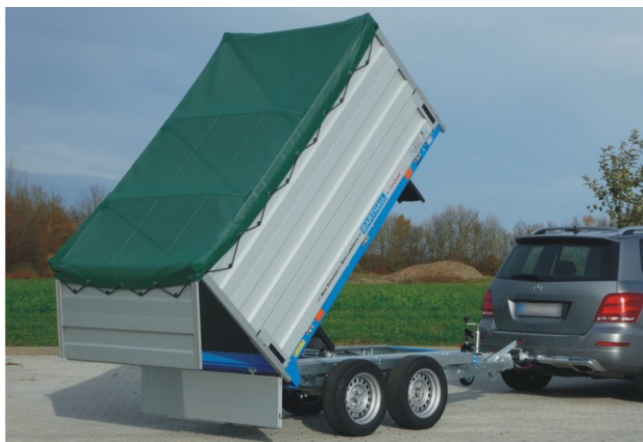
RH 2002 mit Zubehör : Laubaufsatz 700 mm hoch aus Aluminiumprofil an einem Stück gefertigt und hinten mit Pendelbordwand , Flachplane aus luftdurchlässigem Netzgewebe und Stützbügel für Flachplane, speziell für den Einsatz von Laubsauggeräten.
