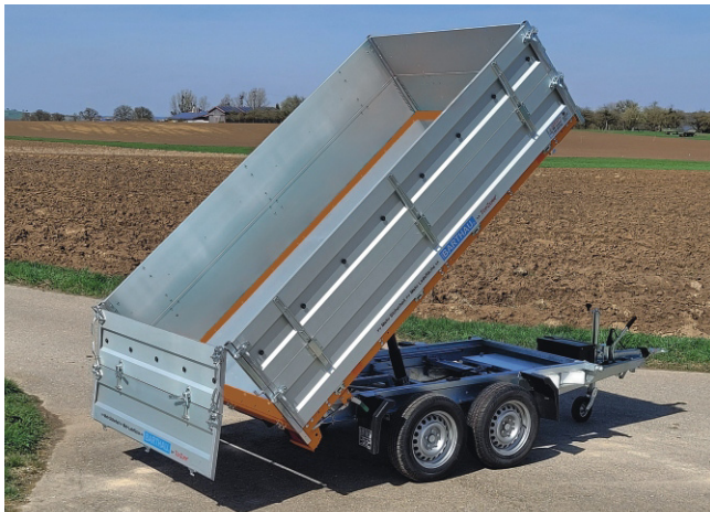
Typ DK hintere Klappe serienmäßig mit Pendelbordwand und mit Zentralverriegelung. (Betätigung mit einem Hebel von der Seite.) Mit Zubehör : Bodenschutzbelag aus 1,5 mm verzinktem Stahlblech auf dem Multiplexboden aufgelegt, keine Durchbiegung . Aluminium-Aufsatz 400mm hoch, werkzeuglos steckbar. Repräsentieren Sie sich in Ihrer Firmenfarbe.
