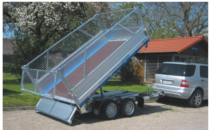
DK 2702 mit Zubehör : Laubgitter feuerverzinkt, 600 mm hoch, werkzeuglos steckbar, 3seitig zum Pendeln.
