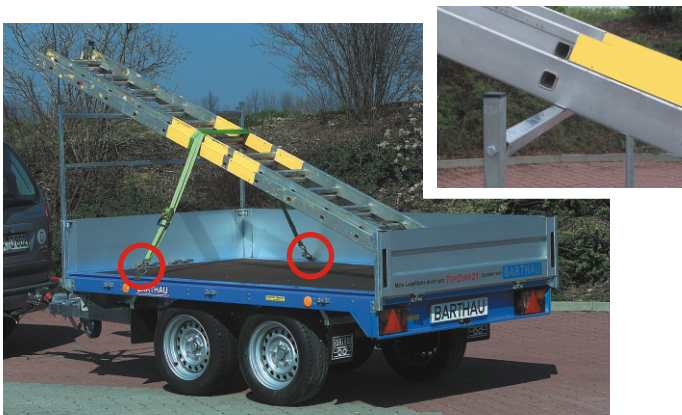
EH 2002 serienmäßig mit hohem Rahmen und 14-Zoll-Bereifung. Aluminium-Bordwände 350 mm hoch, 4seitig abklappbar und werkzeuolos abnehmbar. 4 Stück Eckkrungen gesteckt, versenkte Verschlüsse. Zubehör H-Galerie vorne, oberes Rohr drehbar, paßt sich der Ladung an, z. B. kein Knick in der Alu-Leiter.
