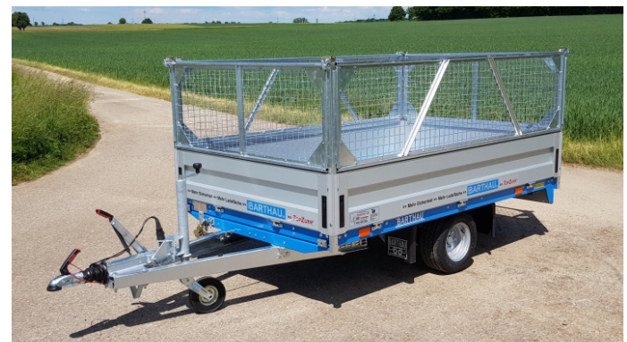
EH 1501 mit Laubgitteraufsatz 600 mm hoch verzinkt. Zum Einsatz mit Laubsaugerät nicht geeignet, da der Luftdruck die Blätter durcheinanderwirbelt und durch das Gitter drückt. Nur für Äste und gröberes Material verwendbar.
