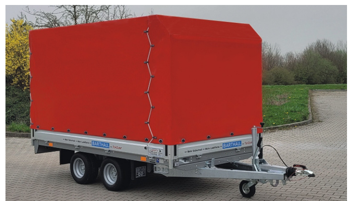
EH 2002 mit Zubehör: Farbbeschichtung aller blauen Rahmenteile in staubgrau. Repräsentieren Sie sich in Ihrer Firmenfarbe. Dachgestell und PVC-Plane in feuerwehrot 1600 mm Ladehöhe.
