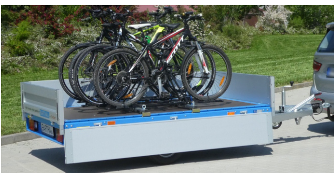
ECO-Toplader mit Zubehör Lastenträger am seitlichen Zurrprofil festgeklemmt. An 2 Lastenträgern können bis zu 9 Fahrradträger montiert werden. Die Lenker dürfen nicht überstehen, sondern müssen an den beiden äußeren Fahrrädern gedreht werden.
