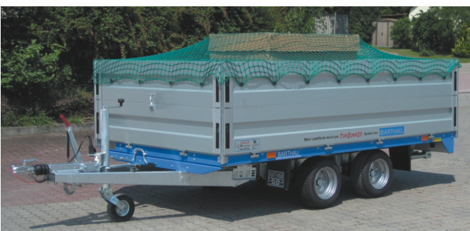
ET 2002 mit Zubehör Stützrad schwer, Aluminium-Aufsatz 350 mm hoch (auch 2x350 mm möglich), Schutznetz mit verstärkten Kanten.
