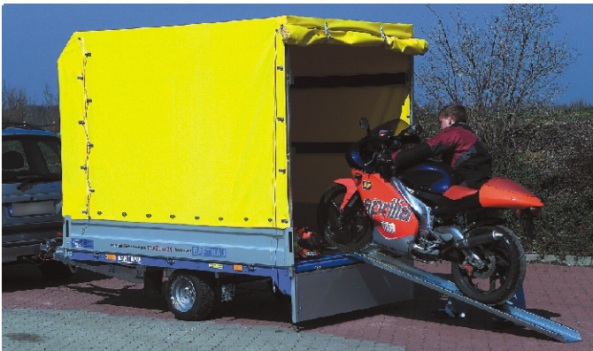
ET 1501 mit Zubehör Dachgestell und Plane sowie Motorradtransportersatz. Das Dachgestell hat 1600mm Ladehöhe und ist vorne windschnittig abgeschrägt. Plane gelb statt serienmäßig hellgrau.
