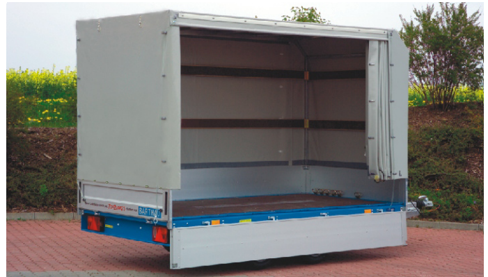
EH 2702 mit Zubehör Dachgestell und PVC-Plane serienmäßig vorne abgeschrägt. PVC-Plane mit Drehverschlüssen unten , an den Ecken mit Zickzackverschluss . Die Schiebeplane ist von der Schräge ab nach hinten auf der rechten und der linken Seite als Zubehör lieferbar und von hinten und vorne zu schieben. Leicht zu Bedienen, schnellere Beladung.
