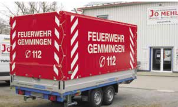
SP Zubehör PVC-Plane und Dachgestell aus verzinktem Vierkantrrohr geschraubt mit 100 mm Steigung. Besonders zu empfehlen ist, wenn das Dachgestell und die Plane als Schiebeplane ausgerüstet werden. Die Schiebeplane mit Leichtlaufrollen aus Metall lässt sich spielend leicht nach vorne ziehen, der Anhänger ist schnell zu öffnen. Bei normaler Plane lässt sich eine große Plane nur schwer nach oben werfen und der Wind weht sie leicht wieder herunter. Jede Höhe für Anhänger lieferbar, jedoch nicht mit einschiebbarer Plane (Kasackplane) und nicht mit Zollverschluss.
