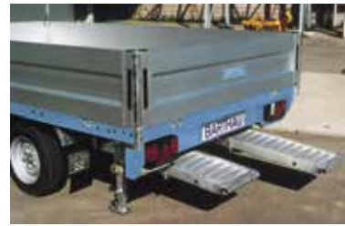
Aluminium-Auffahrampen, unter der Pritsche eingeschoben mit Klappstützen. (Bei kleinen Rädern 13 Zoll nur mit Klappkurbelstützen lieferbar - Mehrpreis, Abbild. rechts).
