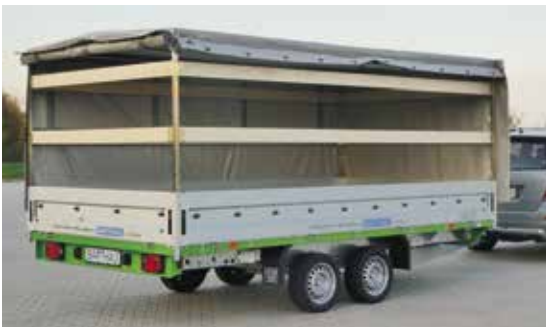
Dachgestell und PVC-Plane 3-seitig mit automatischem Planenaufroller. Durch den automatischen Planenaufroller ist die Plane schnell zu öffnen und schnell zu schließen, was für den Fahrer eine wesentliche Zeitersparnis bedeutet.
