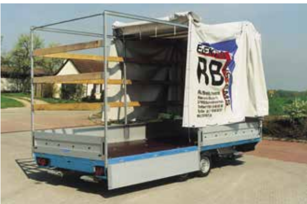
Typ SP mit Aluminiumrampen und mit Faltverdeckgestell , für Kranverladung geeignet, als Zubehör, dazu Bordwände mit Mittelrungen .
