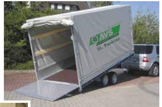
SP Zubehör PVC-Plane und Dachgestell aus verzinktem Vierkantrrohr geschraubt mit 100 mm Steigung. Besonders zu empfehlen ist, wenn das Dachgestell und die Plane als Schiebeplane ausgerüstet werden. Die Schiebeplane mit Leichtlaufrollen aus Metall lässt sich spielend leicht nach vorne ziehen, der Anhänger ist schnell zu öffnen. Bei normaler Plane lässt sich eine große Plane nur schwer nach oben werfen und der Wind weht sie leicht wieder herunter. Jede Höhe für Anhänger lieferbar, jedoch nicht mit einschiebbarer Plane (Kasackplane) und nicht mit Zollverschluss.
