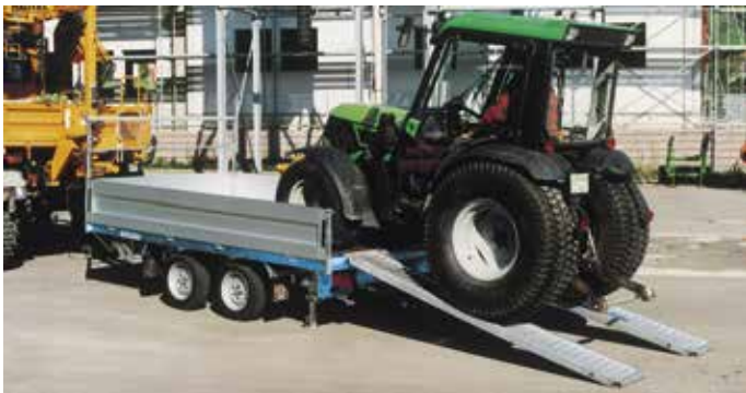
Aluminium-Auffahrampen, unter der Pritsche eingeschoben mit Klappstützen. (Bei kleinen Rädern 13 Zoll nur mit Klappkurbelstützen lieferbar - Mehrpreis, Abbild. rechts).
