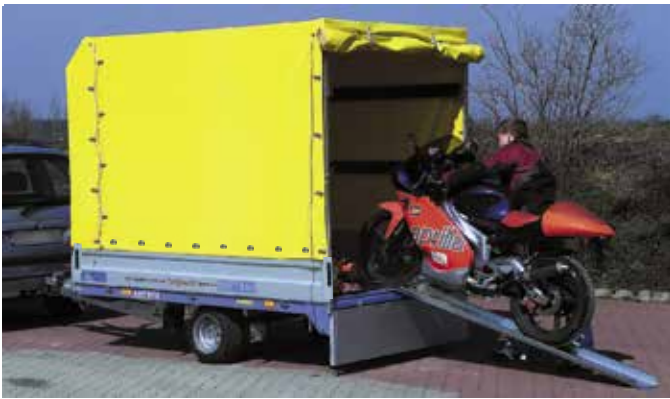
ET 1501 mit Zubehör Dachgestell und Plane sowie Motorradtransportersatz. Das Dachgestell hat 1600mm Ladehöhe und ist vorne windschnittig abgeschragt. Plane gelb statt serienmäßig hellgrau.
