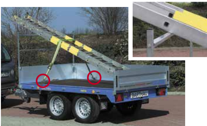
EH 2002 serienmäßig mit hohem Rahmen und 14-Zoll-Bereifung. Aluminium-Bordwände 350 mm hoch, 4seitig abklappbar und werkzeuglos abnehmbar. 4 Stück Eckrungen gesteckt, versenkte Verschlüsse. Zubehör H-Galerie vorne, oberes Rohr drehbar, paßt sich der Ladung an, z. B. kein Knick in der Alu-Leiter.
