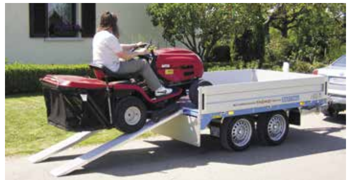
EH 2002 befahrbar durch Zubehör Aluminium-Rampen 2000 mm lang. Zum Transport können die Rampen in Halterungen unter der Ladefläche eingeschoben oder lose auf den Anhänger gelegt werden.
