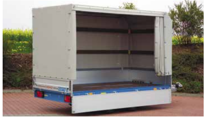
EH 2702 mit Zubehör Dachgestell und PVC-Plane serienmäßig vorne abgeschragt. PVC-Plane mit Drehverschlüssen unten , an den Ecken mit Zickzackverschluss . Die Schiebeplane ist von der Schräge ab nach hinten auf der rechten und der linken Seite als Zubehör lieferbar. Leicht zu Bedienen, schnellere Beladung.
