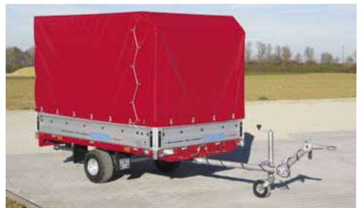
ET 751 mit Zubehör höhenverstellbare Zugdeichsel, Stützrad schwer, Rahmenteile rot, Dachgestell und PVC-Plane in feuerwehrot 1600 mm Ladehöhe.
