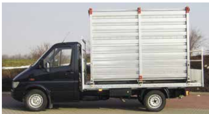
Pritsche aufgebaut auf Peugeot Fahrgestell Zubehör Stirnwand vorne erhöht um 400 mm, Galerie vorne und hinten, Materialcontainer.
