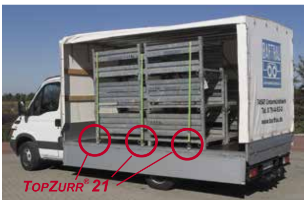
Pritsche aufgebaut auf IVECO Fahrgestell Zubehör Dachgestell und Plane mit Beschriftung
