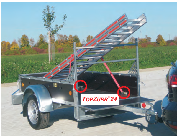
KH 751 neu serienmäßig mit 4 Zurrpunkten TOPZURR®24 innerhalb der Ladefläche, mit Zubehör H-Galerie.
