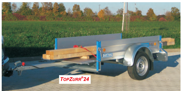
KA 751 neu serienmäßig mit 4 Zurrpunkten TOPZURR®24 innerhalb der Ladefläche, mit Zubehör um 50 cm ausziehbare Zugdeichsel .
