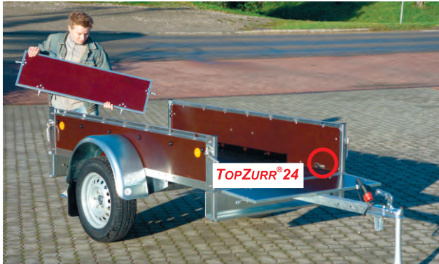
KH 751 serienmäßig mit Gurtleiste seitlich, vorderer Klappe und abnehmbarer hinterer Klappe.
