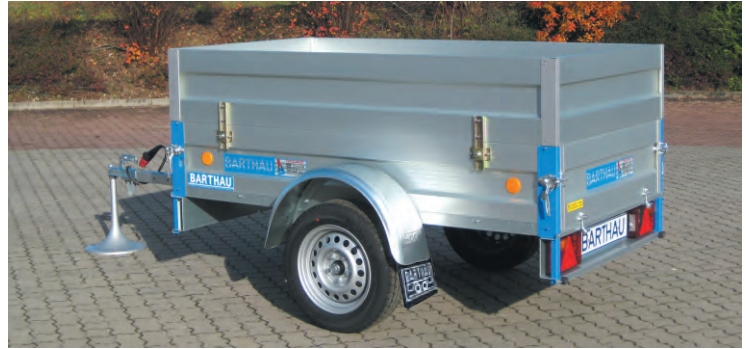
KA 751 mit Zubehör Aufsätze 350 mm hoch aus eloxiertem Aluminium.
