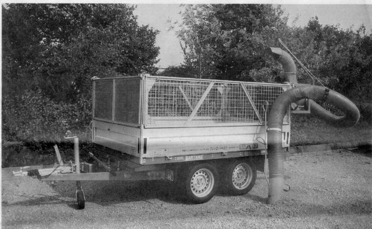
Mit der Größe 2,51 x 1,56 m und einer Bordwandhöhe von 350 mm und Gesamtgewichten zwischen 1500 und 2000 kg ist der Rückwärtskipper RT/RH als Standardkastenanhänger für Materialtransporte geeignet. Foto: Barthau
