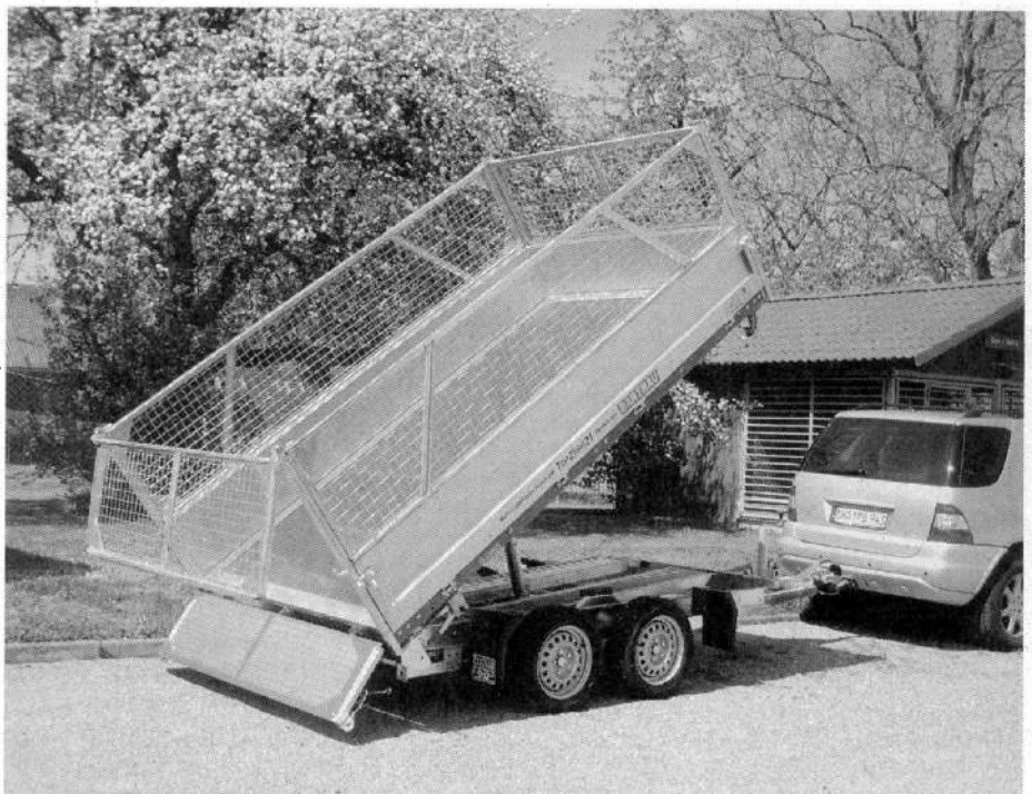
Dreiseitenkipper/Gerätetransportanhänger (DG) können mit Aluminiumaufsätzen als Zubehör ausgestattet werden. Foto: Barthau
