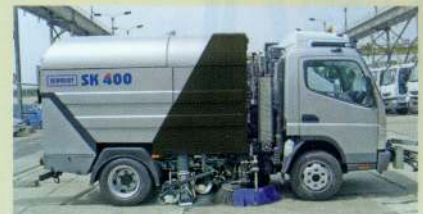
Im Transportbereich erreicht die Kehrmaschine SK 400 eine Geschwindigkeit von bis zu 90 km/h und sichert somit eine hohe Flexibilität. | Foto: Schmidt.
