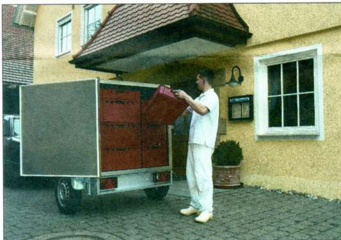
DER KLEINE KÜHLANHÄNGER KANN von PKWs gezogen werden oder stehend als „Zusatzkühlhaus“ benutzt werden. Foto: Barthau
