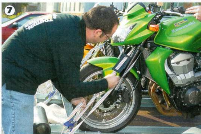
5. Die losen Gurtenden werden sorgfältig gesichert. Im 100-km/h-Fahrtwind würden sie sonst zu Peitschen und könnten sich eventuell sogar ganz lösen.
