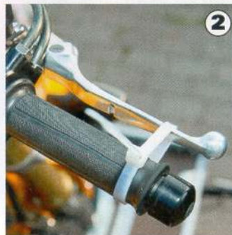
2. Steht das Vorderrad in seiner Halterung, fixiert ein Helfer als Erstes die Vorderradbremse.
