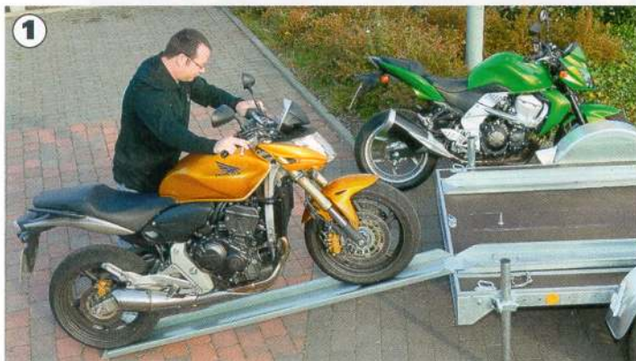
1. Das Motorrad hilft schieben: Mit etwas Gefühl an der Kupplung lässt sich die Maschine im ersten Gang fast ohne Kraftaufwand auf den Hänger fahren. Bei hohen Ladeflächen empfiehlt sich eine Zwischenstufe (Schemel oder Bierkiste) für den sicheren Aufstieg.
