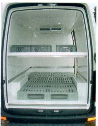
Dank integrierter Kühlanlage kommen die Ausbaufahrzeuge ohne Dachaufbauten aus.
