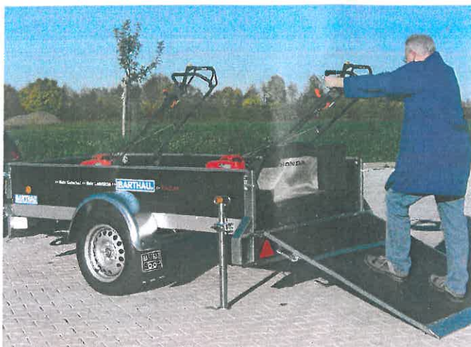
Pkw-Gewerbe-Anhänger mit steckbarer Laderampe. Die QL-Version (rechts) ist aus Voll-Aluminium und besitzt ebenfalls das ZopZurr24-Rahmensicherungssystem, welches die Zurrkräfte in den Rahmen einleitet (Barthau).
