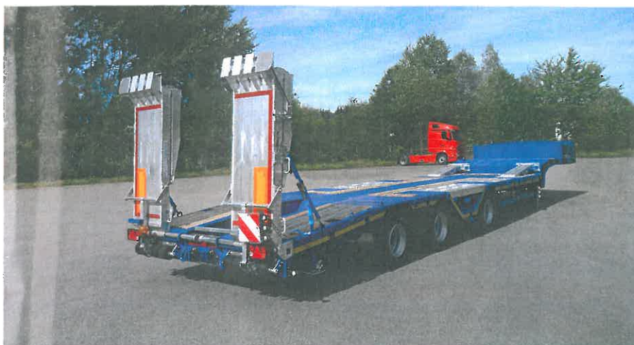
Aluminium-Verladeschienen Typ VFR von Altec. Durch die Verwendung von Profilbausätzen sind Tragkräfte bis 60 t zu erreichen.
