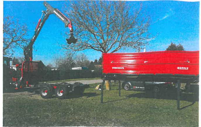
Kipperaufsatz auf Beha Rückewagen T1100. Der Umbau vom Kipper zum Rückewagen erfolgt in knapp 15 Minuten: Kipper mit Kran anheben, auf Stützen stellen und der T1100 ist für den Rückeeinsatz fertig umgebaut. Der Kran 7070 hat eine Kragweite von 7 m und 7 t maximale Tragkraft.
