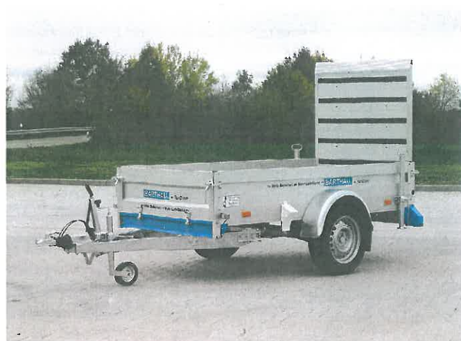
Pkw-Gewerbe-Anhänger mit steckbarer Laderampe. Die QL-Version (rechts) ist aus Voll-Aluminium und besitzt ebenfalls das ZopZurr24-Rahmensicherungssystem, welches die Zurrkräfte in den Rahmen einleitet (Barthau).
