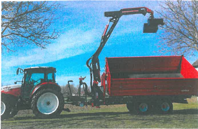
Kipperaufsatz auf Beha Rückewagen T1100. Der Umbau vom Kipper zum Rückewagen erfolgt in knapp 15 Minuten: Kipper mit Kran anheben, auf Stützen stellen und der T1100 ist für den Rückeeinsatz fertig umgebaut. Der Kran 7070 hat eine Kragweite von 7 m und 7 t maximale Tragkraft.
