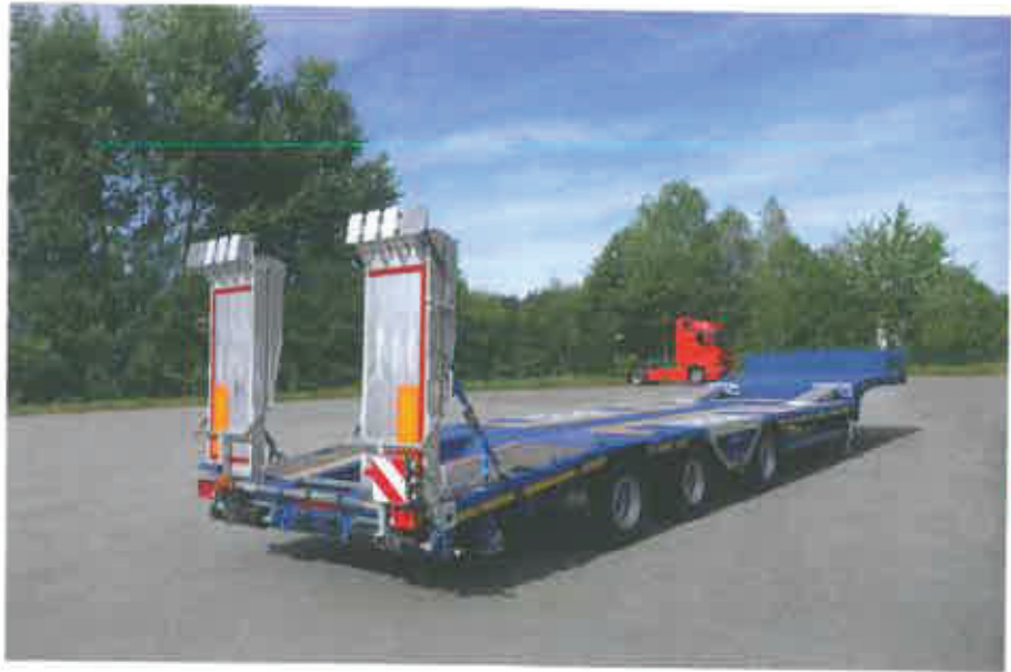
Aluminium-Verladeschienen Typ VFR von Altec. Durch die Verwendung von Profilbausätzen sind Tragkräfte bis 60 t zu erreichen.
