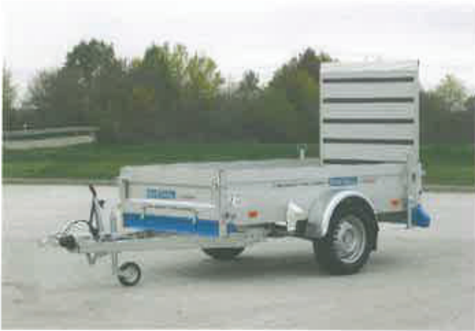
Pkw-Gewerbe-Anhänger mit steckbarer Laderampe . Die QL-Version (rechts) ist aus Voll-Aluminium und besitzt ebenfalls das ZopZurr24-Rahmensicherungs-system, welches die Zurrkräfte in den Rahmen einleitet (Barthau).
