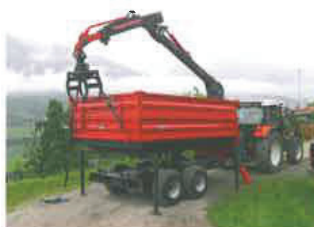
Der Kipperaufsatz auf BEHA Rückewagen T1100 (links). Schneller und einfacher Umbau vom Kipper zum Rückewagen: Kipper mit mit Kran anheben, auf Stützen stellen und der T1100 ist für den Rückeeinsatz binnen 15 Minuten fertig umgebaut.
