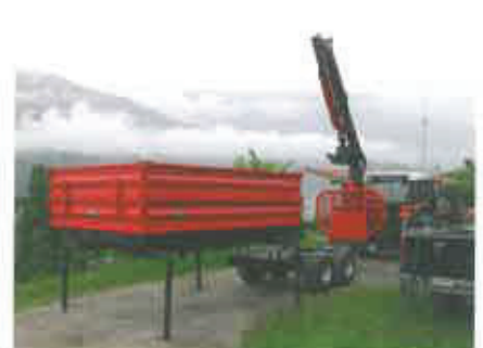
Der Kipperaufsatz auf BEHA Rückewagen T1100 (links). Schneller und einfacher Umbau vom Kipper zum Rückewagen: Kipper mit mit Kran anheben, auf Stützen stellen und der T1100 ist für den Rückeeinsatz binnen 15 Minuten fertig umgebaut.
