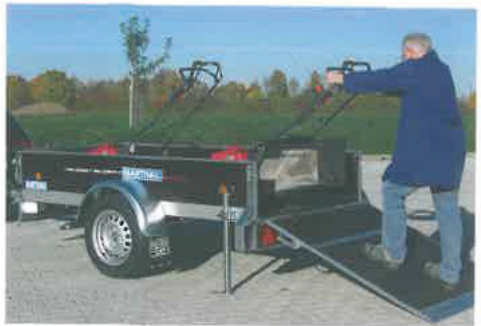
Pkw-Gewerbe-Anhänger mit steckbarer Laderampe . Die QL-Version (rechts) ist aus Voll-Aluminium und besitzt ebenfalls das ZopZurr24-Rahmensicherungs-system, welches die Zurrkräfte in den Rahmen einleitet (Barthau).
