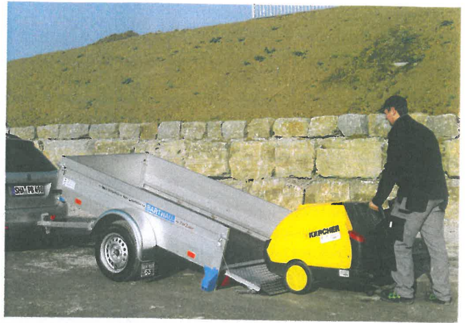
Die QL-Version ist aus Voll-Aluminium und besitzt ebenfalls das TopZurr24 Rahmensicherungs-system, welches die Zurrkräfte in den Rahmen einleitet.
