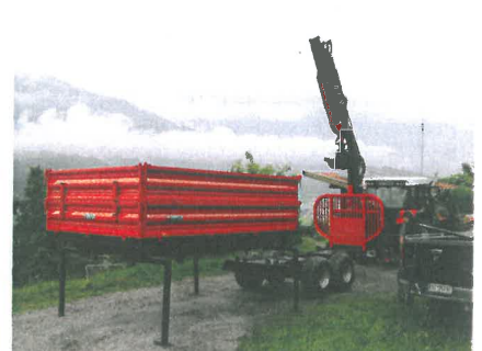
Der Kipperaufsatz auf BEHA Rückewagen T1100 (links). Schneller und einfacher Umbau vom Kipper zum Rückewagen: Kipper mit mit Kran anheben, auf Stützen stellen und der T1100 ist für den Rückeeinsatz binnen 15 Minuten fertig umgebaut.
