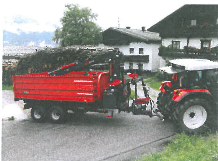
Der Kipperaufsatz auf BEHA Rückewagen T1100 (links). Schneller und einfacher Umbau vom Kipper zum Rückewagen: Kipper mit mit Kran anheben, auf Stützen stellen und der T1100 ist für den Rückeeinsatz binnen 15 Minuten fertig umgebaut.
