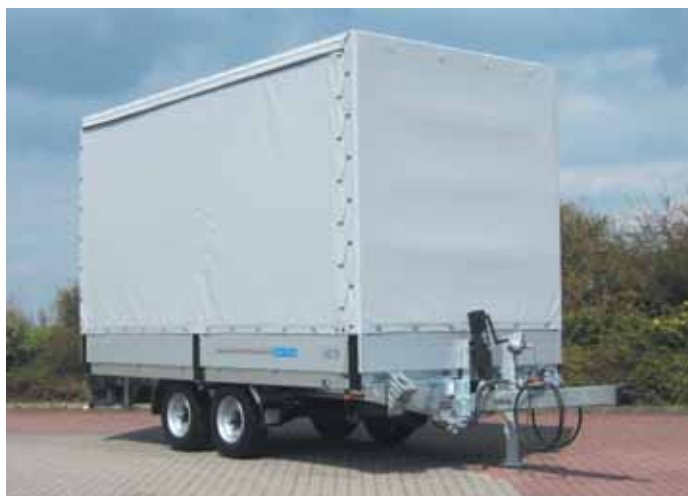
Typ LH mit Zubehör Faltverdeckgestell für schnelle Kranbeladung. Dach und Plane schieben sich vorne zu einem Paket zusammen.
