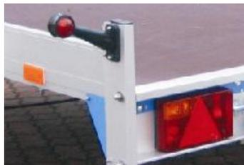
Umrisssleuchte links mit Gummihals und Rückleuchte (verwendet bei Anhänger mit 1860 mm Breite)
