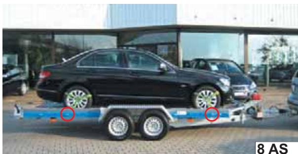
Stahl-Autotransporter... jedes Rad **einzel**n sicherbar.
