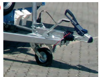
CH 2702 mit Zubehör: Sonderhöhe von 1850 mm Innenhöhe. Außerdem hat dieser Hochlader eine Sicherheitskupplung an der V-Deichsel montiert und Stoßdämpfer für ruhiges und sicheres Fahren. Als Tandemfahrzeug ist er serienmäßig mit einem schweren Stützrad ausgestattet.
