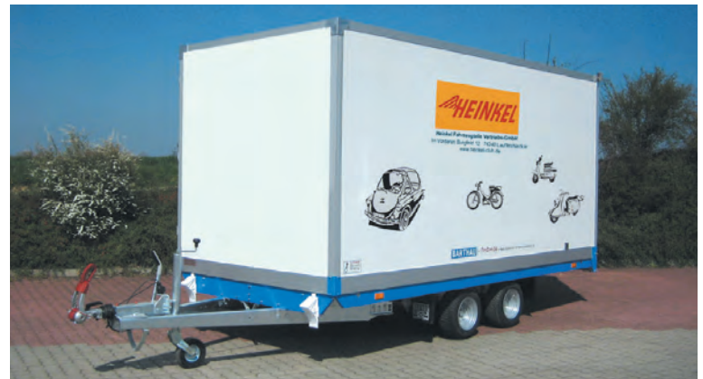
CH 2702 mit Zubehör: Sonderhöhe von 1850 mm Innenhöhe. Außerdem hat dieser Hochlader eine Sicherheitskupplung an der V-Deichsel montiert und Stoßdämpfer für ruhiges und sicheres Fahren. Als Tandemfahrzeug ist er serienmäßig mit einem schweren Stützrad ausgestattet.
