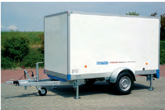
CT 1351 mit Zubehör: 4 Stk. Klappkurbelstützen mit fest angebauter Kurbel hinten und vorne montiert. Gesamthöhe 2 m für Tiefgarage.
