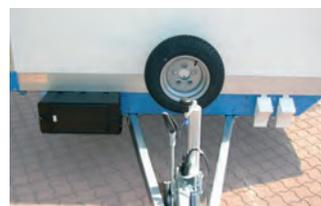
**Ersatzrad mit Halterung** vorne an der Stirnwand montiert (gegen Mehrpreis).
