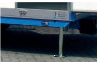
**Klappkurbelstützen mit extra Kurbel.** Umklappbar und stufenlos einstellbar, hinten unter der Pritsche montiert. Es können wahlweise 4 Stk. hinten und vorne montiert werden (gegen Mehrpreis).
