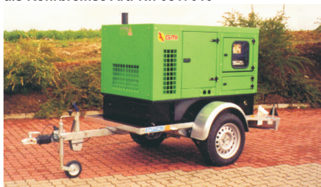
FGPK 1351 Starrdeichsel mit Auflaufbremse als Rohrbremse Art.-Nr. 0817010
