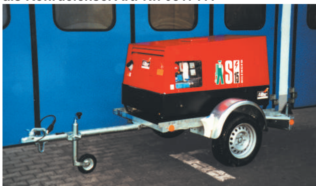
FGPK 751 Starrdeichsel ohne Bremse als Rohrdeichsel Art.-Nr. 0817111
