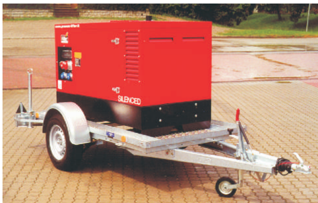
FGPK 1601 Starrdeichsel mit Auflaufbremse als V-Bremse Art.-Nr. 0957010
