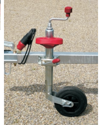
PK 751 mit Zubehör vordere Klappe, ausziehbarer Deichsel um 500 mm und Stützrad leicht mit Feststellbremse (Pinstop) inkl. 2 Unterlegkeile. Der Bolzen des Pinstops verhindert das Wegrollen. Einsatzpflicht der Unterlegkeile an Steigungen, der Pinstop ersetzt keine Handbremse. Set inkl. rotem Rangiergriff zum Bewegen des Anhängers.
