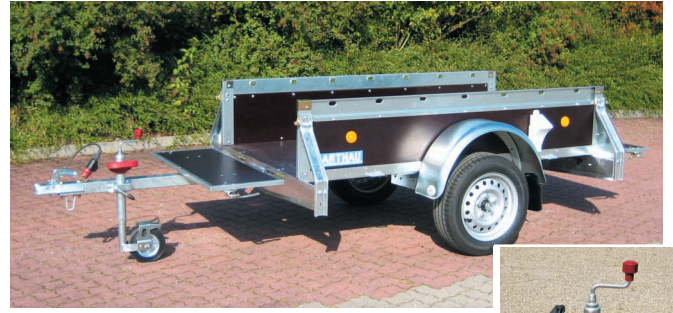
PK 751 mit Zubehör vordere Klappe, ausziehbarer Deichsel um 500 mm und Stützrad leicht mit Feststellbremse (Pinstop) inkl. 2 Unterlegkeile. Der Bolzen des Pinstops verhindert das Wegrollen. Einsatzpflicht der Unterlegkeile an Steigungen, der Pinstop ersetzt keine Handbremse. Set inkl. rotem Rangiergriff zum Bewegen des Anhängers.
