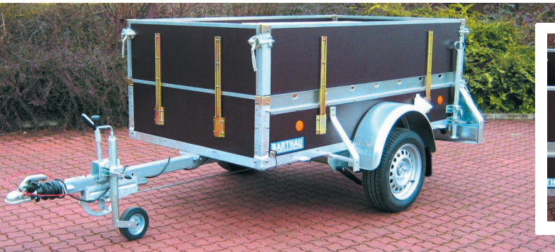
PK 1001 serienmäßig mit Rohrbremse und Stützrad leicht. Abbild. mit Zubehör: Aufsatz 400 mm hoch, Stoßdämpfern u. 2 Stück Rohrstützen hinten mit doppelter Klemmhalterung.
