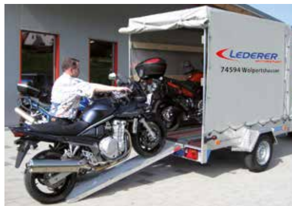
Ein-Mann-Verladung durch Stand-schiene mit verstellbarer Radan-lage und Motorradwippe für alle Motorrad-anhänger . (Zubehör)
