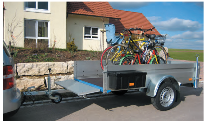
QL 751 mit Zubehör: Stützrad leicht, Rohrstützen, Staubox, Lastenträger und Fahrradträger . Der Lastenträger ist über die Ladungssicherung befestigt und kann so leicht auf- und abmontiert werden, ohne den Anhängerboden zu beschädigen. Die Fahrträger sind auf den Lastenträger aufgesetzt.
