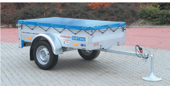
QL 751 mit Zubehör: Flachplane, serienmäßig in hellgrau , andere Farben gegen Mehrpreis lieferbar. Lange freie Deichsellänge - serienmäßig ausziehbar um 500mm bei allen unbremsten Typen.
