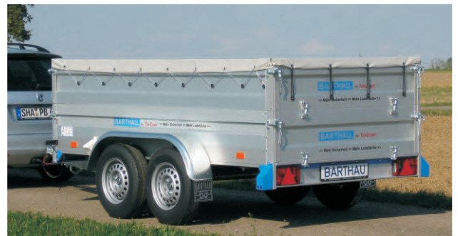
QL 2702 mit Zubehör: Aluminium-Aufsatz 400 mm hoch , Flachplane .
