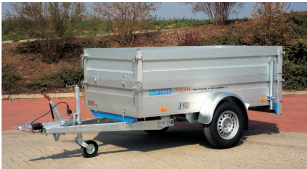
QL 1801 mit Zubehör: Aluminium-Aufsatz 400 mm hoch , Rohrstützen beidseitig und Stützrad schwer.
