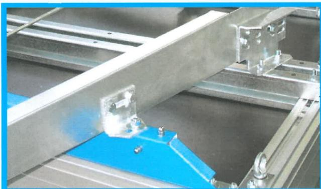
**Deichselbefestigung** an Traverse vorn, große Verschraubung mit **starkem Winkel.**
