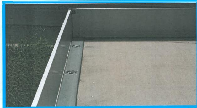
Vorgegebene, fest verschraubte Verzurrpunkte, dadurch **kein optimales "Niederzurren"**. Platzverlust durch Zurrpunkte auf der Ladefläche.
