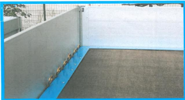
Durch die Barthau Ladungssicherung besteht eine Verzurrmöglichkeit mit optimaler Raumausstattung somit auch kein Verlust an Ladefläche. **"Niederzurren" kein Problem.**
