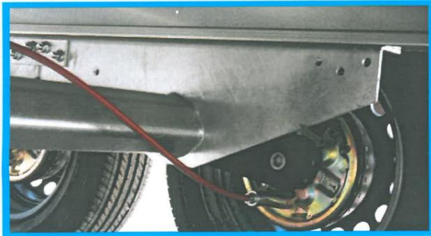
**Extra lange Auflage** der Achsen am Rahmen für maximale Stabilität & Sicherheit. Gekanteter Achsträger 710mm darauf liegt Rahmen des Anhängers auf schluckt Schwingungen = **ruhiges Fahrverhalten**
