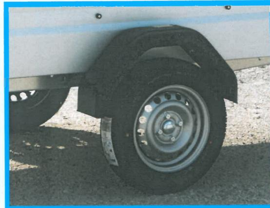
Kunststoffkotflügel, Schwingungen während der Fahrt, Bruchgefahr durch Kälteeinwirkung und Ausbleichung durch UV-Strahlen.
