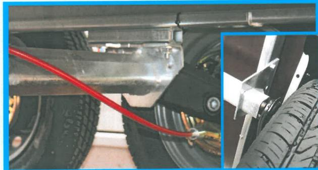
Kleine Achsauflage, bei Tandemachsen sind die Achsen nicht miteinander verbunden. Kurzer Achsträger stehend mit Rahmen verklemt, keine Schwingungsaufnahme des Aufbaus = **unruhiges Fahrverhalten**
