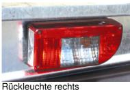
Bezeichnung Art-Nr. Stückzahl 06-752 Leuchte links mit Nebelschlußleuchte, seitlich abger. Leuchte rechts mit Rückfahrscheinw., seitlich abger. 06-753 Rückleuchtendeckel links mit Nebelschlussleuchte 06-639 Rückleuchtendeckel rechts mit Rückfahrscheinwerfer 06-640 Leuchte-Kennzeichen kpl. mit 500mm Snap-In-Kabel 06-738 Leuchte Kennzeichen kpl. ohne Kabel 06-569 Kennzeichenleuchtendeckel 06-570
